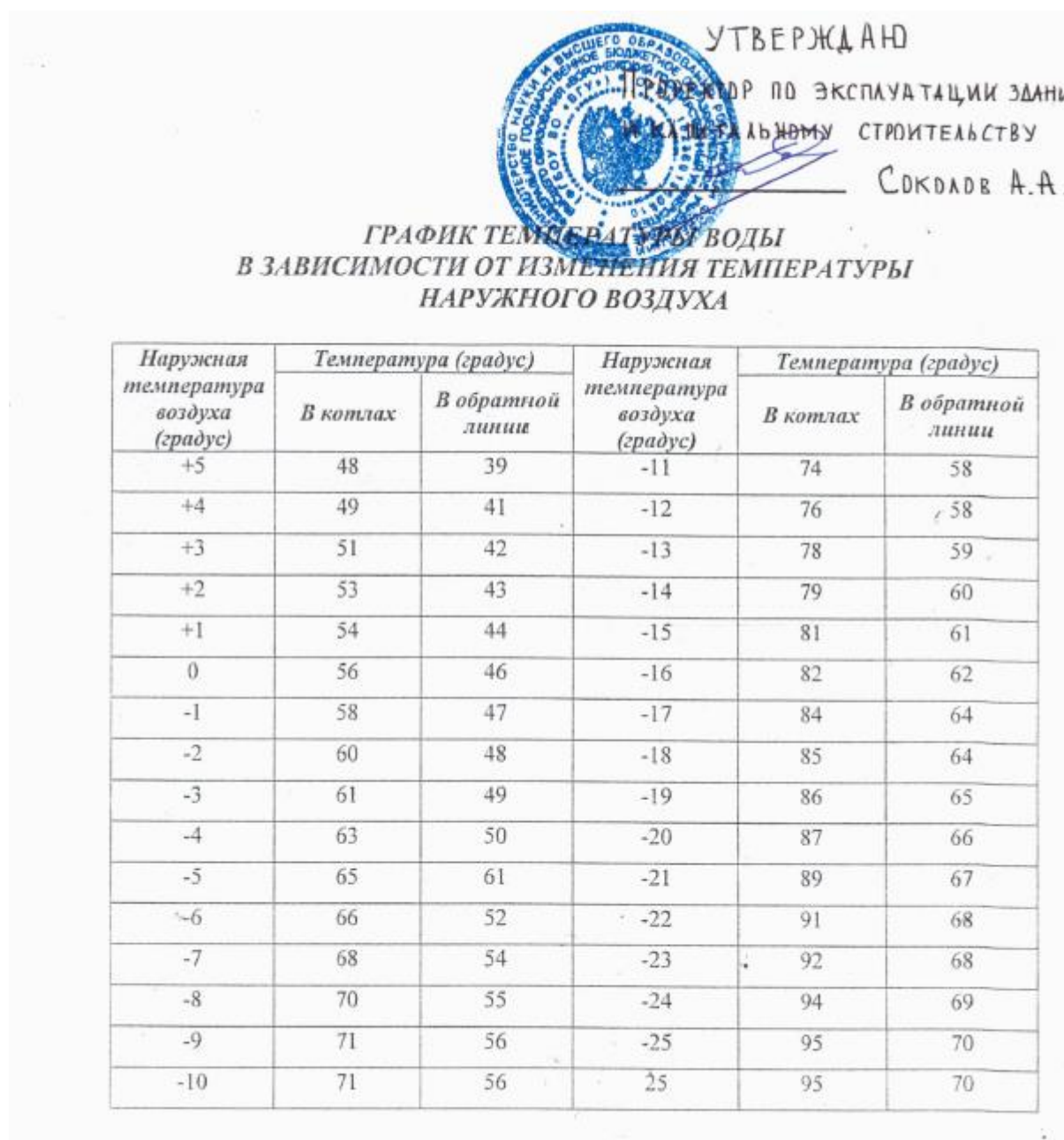
Рисунок 91 - Утвержденный температурный график отпуска тепла в тепловые сети котельной ФГБОУ ВО «ВГУ»
