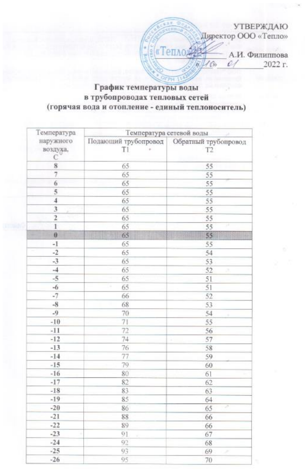
Рисунок 81 - Утвержденный температурный график отпуска тепла в тепловые сети котельной жилой массив Лесная поляна, 15к (без ГВС)
