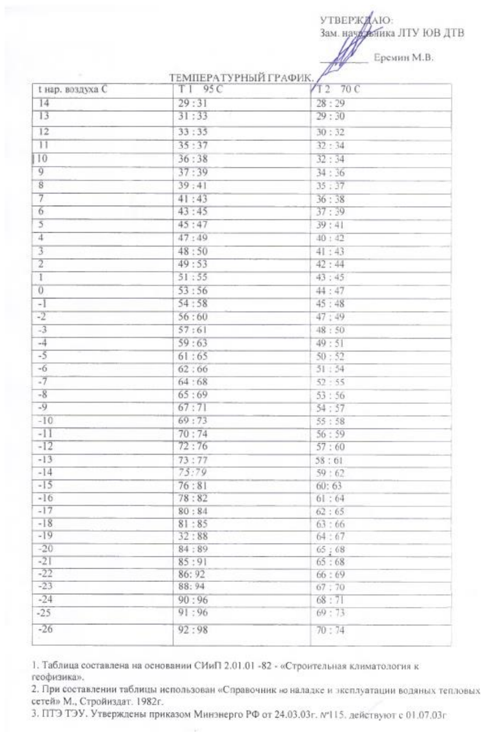
Рисунок 93 – Утвержденный температурный график котельной ЛТУ ЮВ ДТВ - структурное подразделение Центральной дирекции по тепловодоснабжению филиала ОАО «РЖД»
